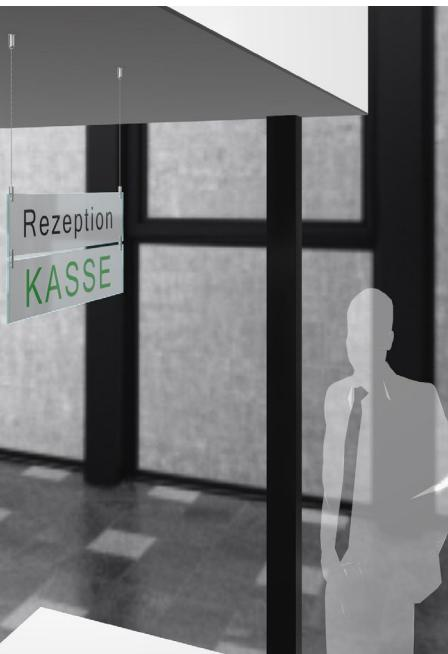
Das Grundmodell „Deckenmontage“ besteht aus je 2 Deckenstücken und Schilderbefestigungen, 2 x 1000 mm Edelstahlseil sowie - je nach Ausführung - 1 bzw. 2 Glasscheiben (thermisch gehärtet, 5 mm stark) im gewählten Format. Diese weisen zwei bzw. vier Bohrungen auf, je nachdem, ob eine Erweiterungsscheibe gewählt wird oder nicht.
